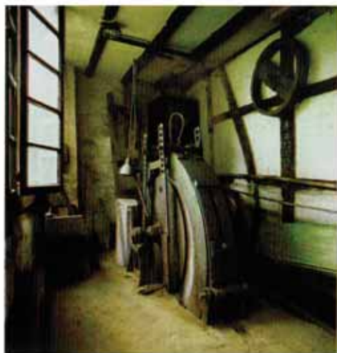
Blick in einen Schleifkotten - Arbeitsraum mit großem Schleifstein für den groben Vorschliff.
