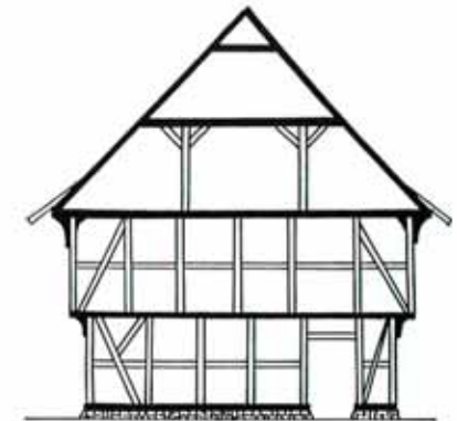
Abb. 3: Prinzip des Stockwerksbaus.
