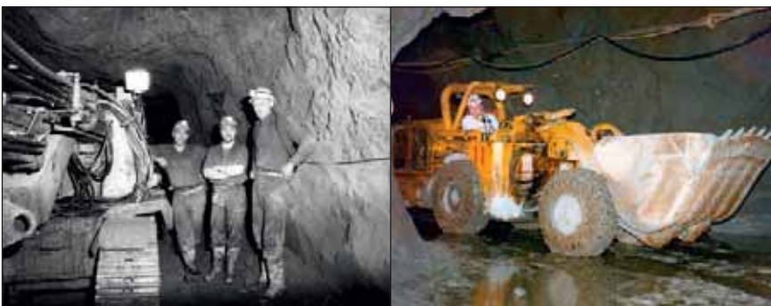
Foto links: Der Bohrwagen mit Raupenfahrwerk erhöhte in den letzten Betriebsjahren die Bohrleistung um ein Vielfaches. Foto rechts: Ebenfalls in den letzten Jahren des Betriebes kamen Fahrlader zum Einsatz (Fotos: Sammlung Siegfried Raimann).
