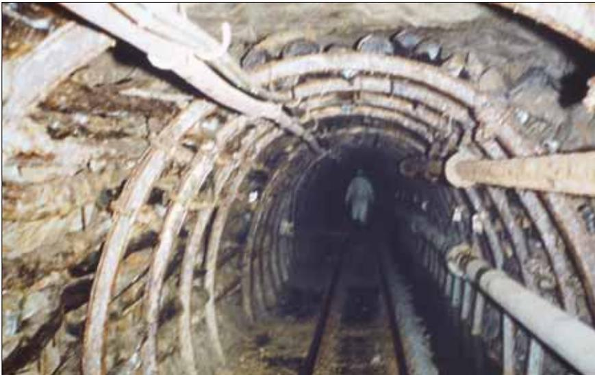
Foto 4: Bald ändert sich das Bild der Strecken: Wände und Decken sind naturbelassen, man sieht die Steine, die durch Stahlbogenausbau in kurzen Abständen gesichert sind.
