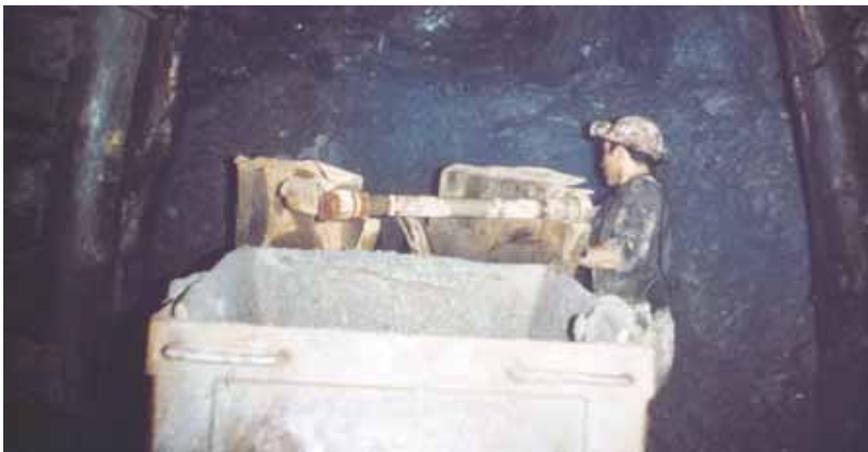
Foto 8: Ein Förderwagen, eine Lore, wird beladen, davor das Gerät zum Räumen des Materials, ein Überkopflader mit Druckluftantrieb.
