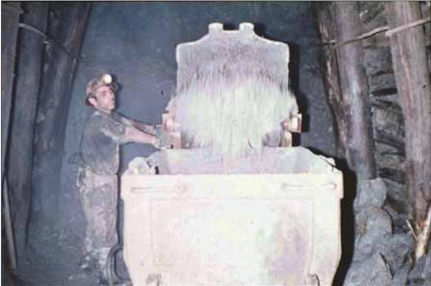
Foto 9: Die Füllung des Baggers wird in die Lore gekippt. Hier ist der Stollen noch befestigt
