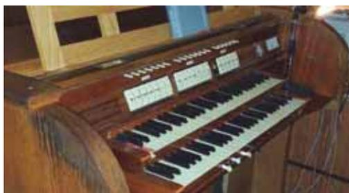
Der Spieltisch mit den Manualen, den Registerwippen und den Schaltern für die Kombinationen. Oben rechts eine Anzeige, die über den Grad der Schwellwerköffnung informiert.
