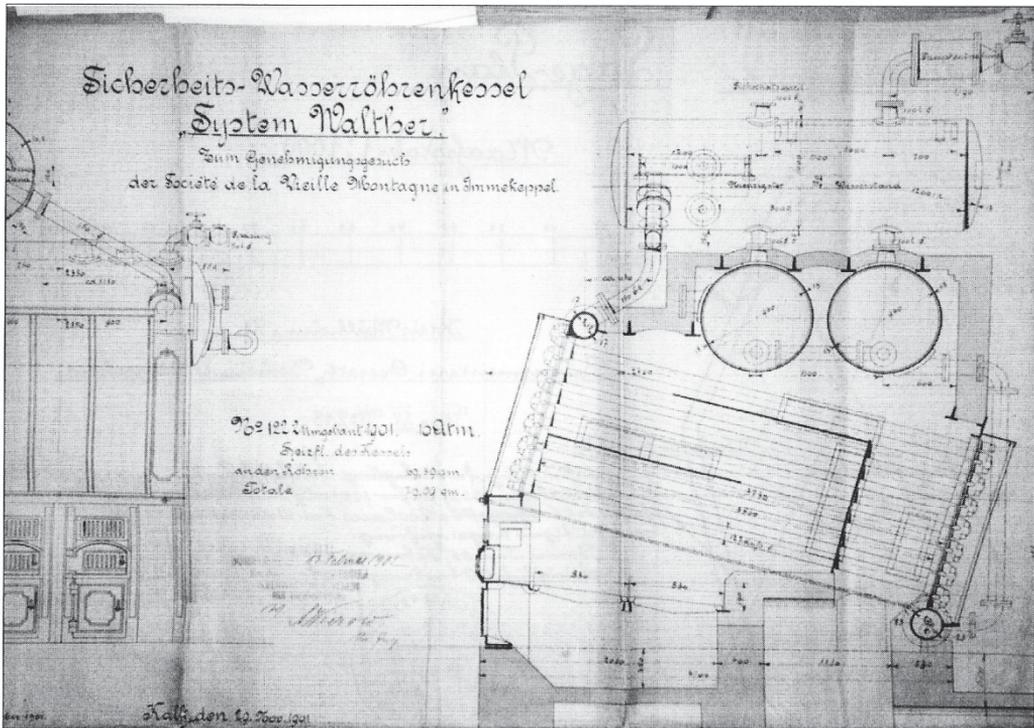
Abb. 8: Konstruktionszeichnung der Dampfkesselanlage am Nikolaus-Schacht von 1902. Der Dampfkessel erzeugte u. a. den Dampf für die Fördermaschine (BBA 80/2804)
