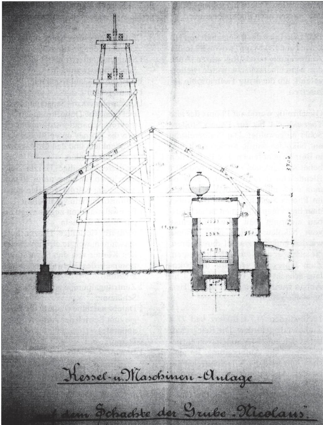
Abb. 7: Konstruktionszeichnung des Fördergerüsts am Nikolaus-Schacht von 1902 (BBA 80/2804)
