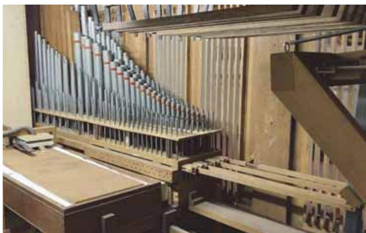
Das geräumige und begehbbare Unterwerk mit leider nur vier Registern. Zu sehen ist links der Windbalg, der für vollkommen gleichbleibenden Luftdruck sorgt. Daneben die Windlade mit den vier Registerschleifen und den vier Trakturen hin zu den Registerzügen rechts im Spielschrank. Auf dem Pfeifenstock die Pfeifen der vier Register.
